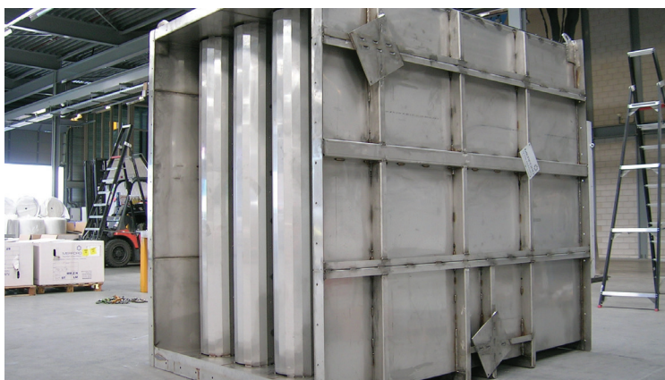
Geluidsdemper type Z uitgevoerd in RVS voor toepassing in chemische industrie
